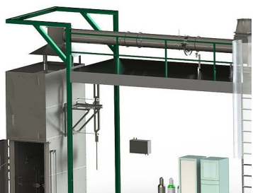
KBT – Sistema per prove al fuoco su cavi elettrici: EN 50399, IEC 60332-3-10 (Sistema di prova)
